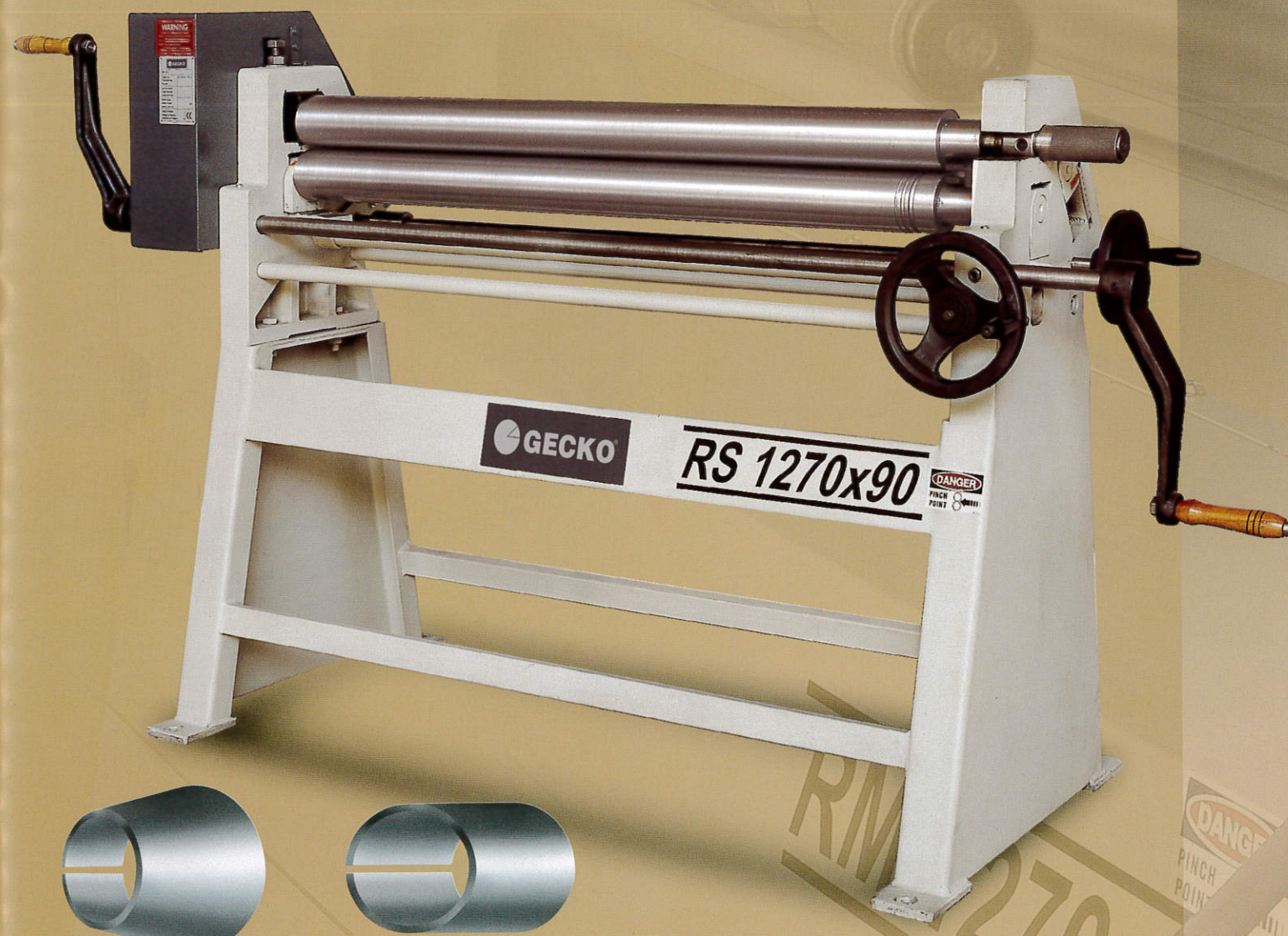
RS Rullo Superiore Apribile Per Estrazione Virola (Standard) Standard Manual Drop End Standard Manuelles Klapplager
